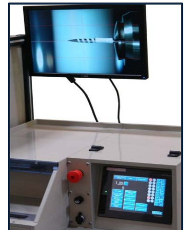
Monitor zur Kontrolle der Lackierung
