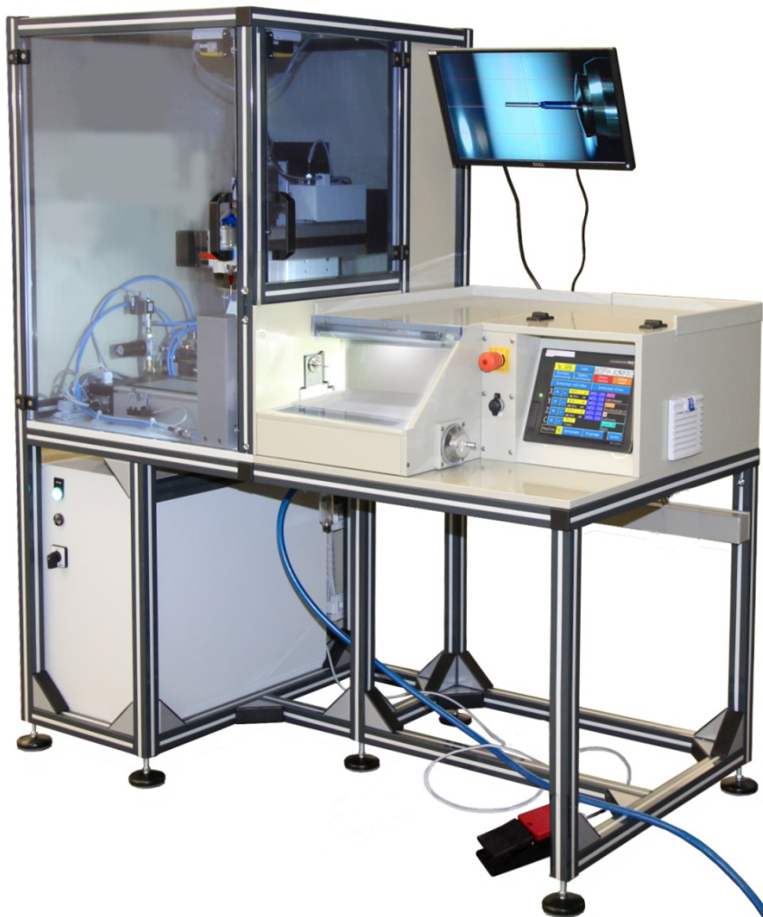
Lackiereinheit mit Drei-Achsen-Führung und druckbasiertem Farbdosiersystem
